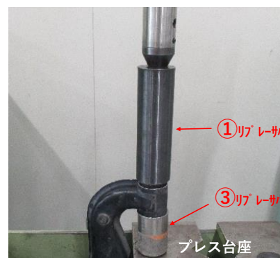
6. リブレサバ イブ B ③をアームの下に入れブッシュの逃げをつくり打ち込む。 (1で③を入れても良いが、アームが不安定になりやすい為リスクがある) リブレサバ イブ B ③を用いずに圧入するとブッシュ内筒が外筒より先にプレス台座に接触しブッシュが損傷するため注意。
