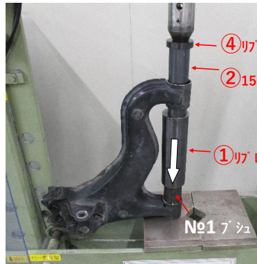
1. 準備工具とロアアームを油圧プレスにセットする。 No.17 シュを先に打ち込む。 ブッシュの向きは右上のA視に示す範囲内になるように取付ける。
