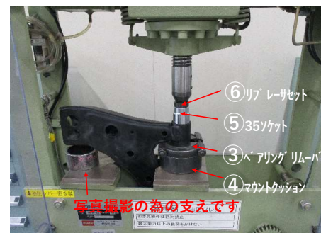
4. 準備工具とアームを油圧プレスにセットする。 なお「写真撮影の支え」は実際の作業では不要です。
