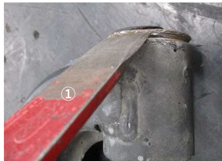
1. No.1、No.2ブシのフランジをタガネ①で起こす。 (ベアリングリムバの歯を入れるため)(2の拡大写真) アーム側を変形させないように注意
