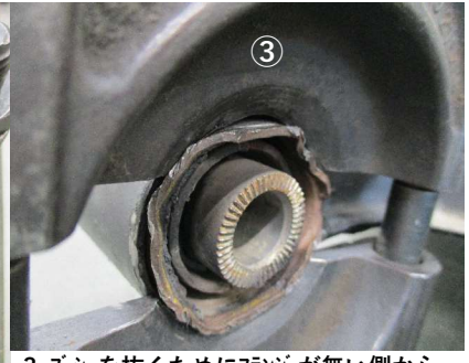
3. ブシを抜くためにフランジが無い側からブシに荷重をかける。その際ベアリングリムバ③でアームを支持出来るよう挟む。
