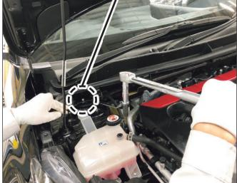
7. ピストンロッドをスパナ(10mm)で保持した 状態でショックアブソーバ(フロント)上部の ピストンナット(M12)を本締めする。
