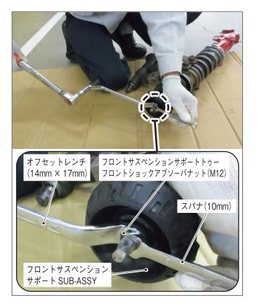
9. フロントサスペンションサポート SUB-ASSY を ストラットマウンティングベアリングにセットする。
