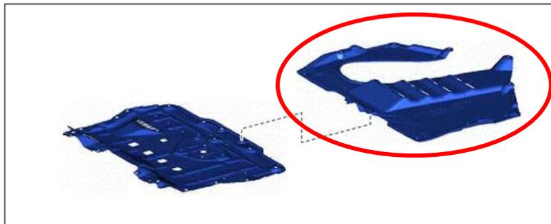
この部品は車両のトランスミッションの下に装着されており、車両の下側を通る空気の流れを調整し空力性能を向上するとともに、チップング（※1）に対して、車両の保護をしている部品となります。
